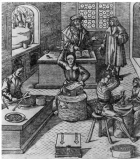
**Fig. 2.** Grabado alemán del siglo XV en el que se observan los distintos oficios ligados a la acuñación a martillo, observándose en la posición inferior derecha a un acuñador con sus herramientas de troquelado (*Visita en 1517 del emperador Maximiliano I a la sala de la moneda de Tyrol*. Xilografía de Hans Burgkmair el Viejo, 1473-1531).
